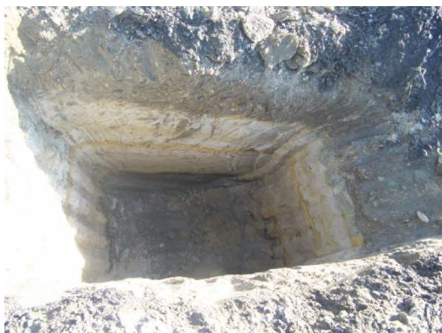
写真-4 北上地方に堆積する粘性の強い粘土
