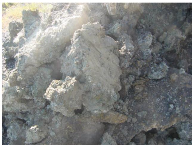
写真-5 北上地方に堆積する粘性の強い粘土
